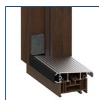
Teplý práh ALU/PVC s termicko přepážkou, PVC podkladem a windstoperem
